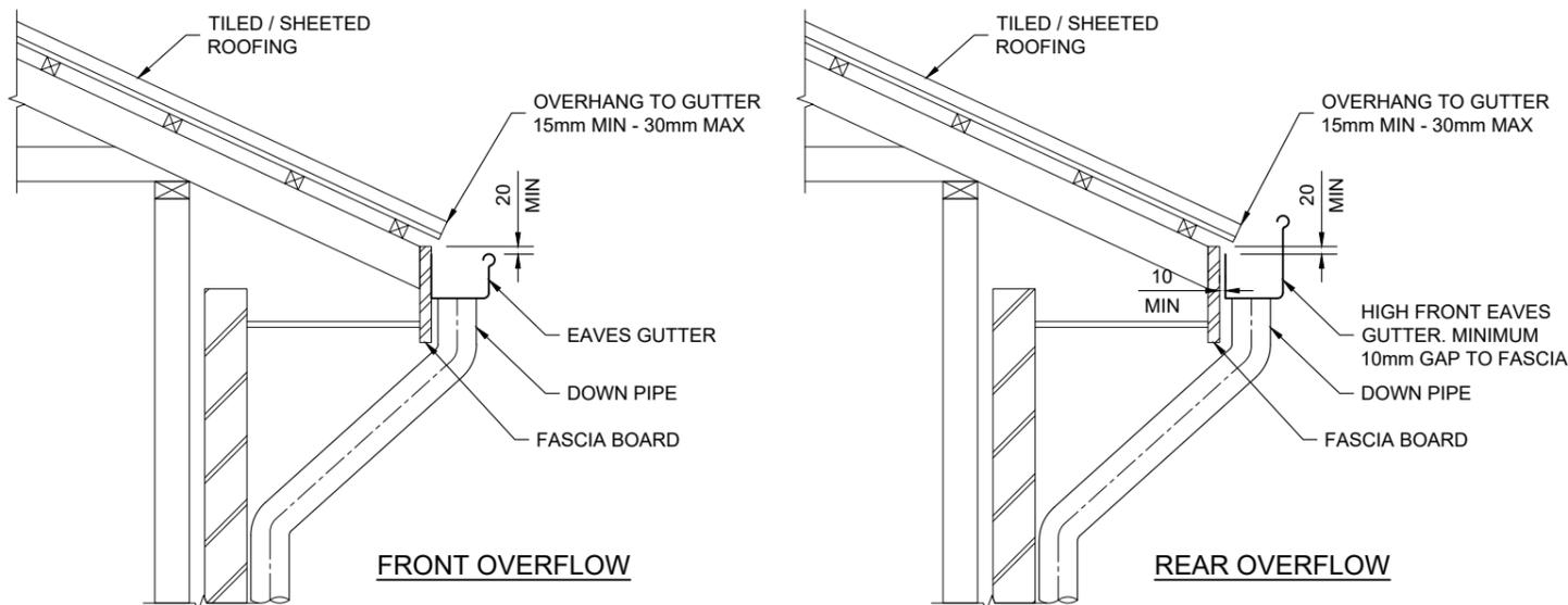
**TYPICAL EAVES GUTTER DETAIL**
